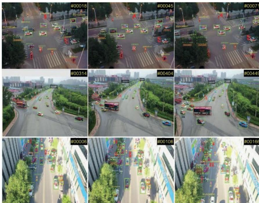
Figure 8 : Identification par vidéo des véhicules en circulation à partir d'un drone<sup>33</sup>.
